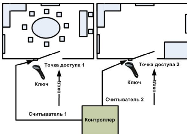
Рис. 2.1.6-3 Двухдверная конфигурация контроллера
