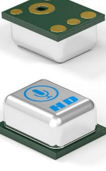
В качестве чувствительного элемента, в микрофоне Stelberry M-70HD применяется миниатюрный MEMS-капсюль с очень высокой чувствительностью
